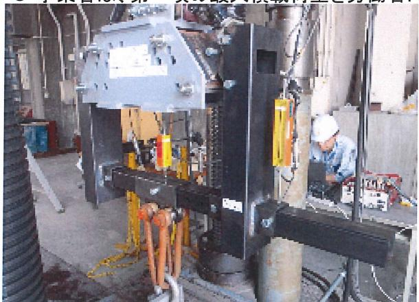
上記により、吊り足場支持金具には、載荷重に対して充分な強度が要求され、これに従い耐力確認試験においては、「つるべい」に設計耐荷重に安全率を2.5とした荷重を加えた性能試験を行っています。
